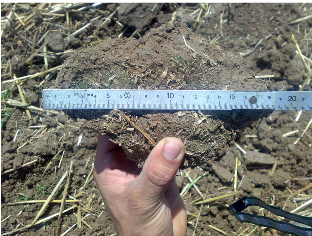
Obrázek 8 - Měření hrudovitosti (foto: J. Švojgr)
