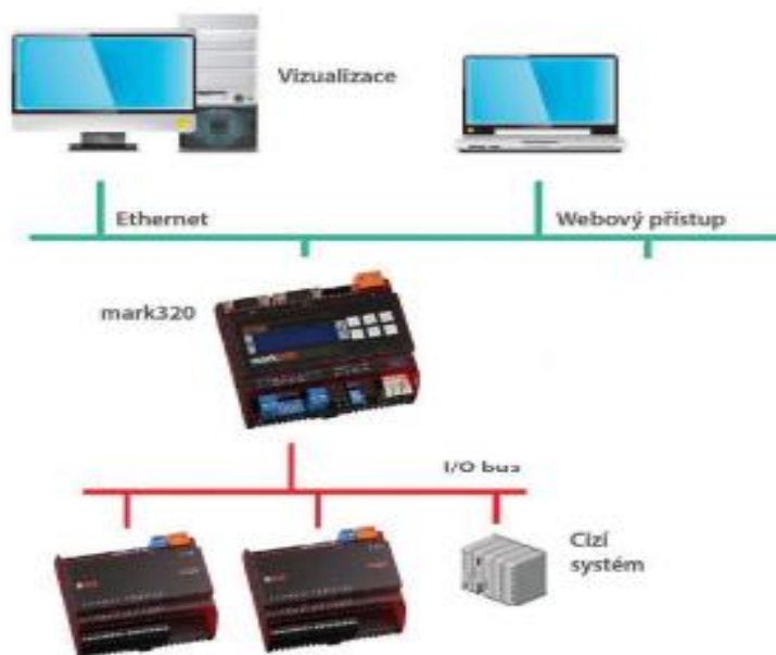
Obr. 4. - Zapojení komunikace vč. rozšiřujících modulů
