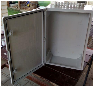
Obr. 14. - Rozvaděč bez montážního panelu, kabelové průchodky (foto autor)
