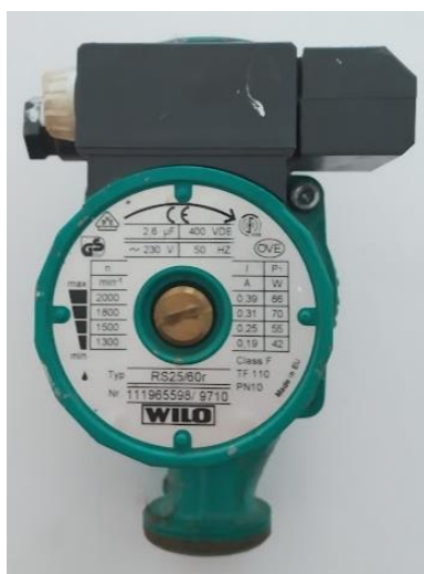
Obr. 9. - Oběhové čerpadlo WILO RS25/60r (foto autor)
