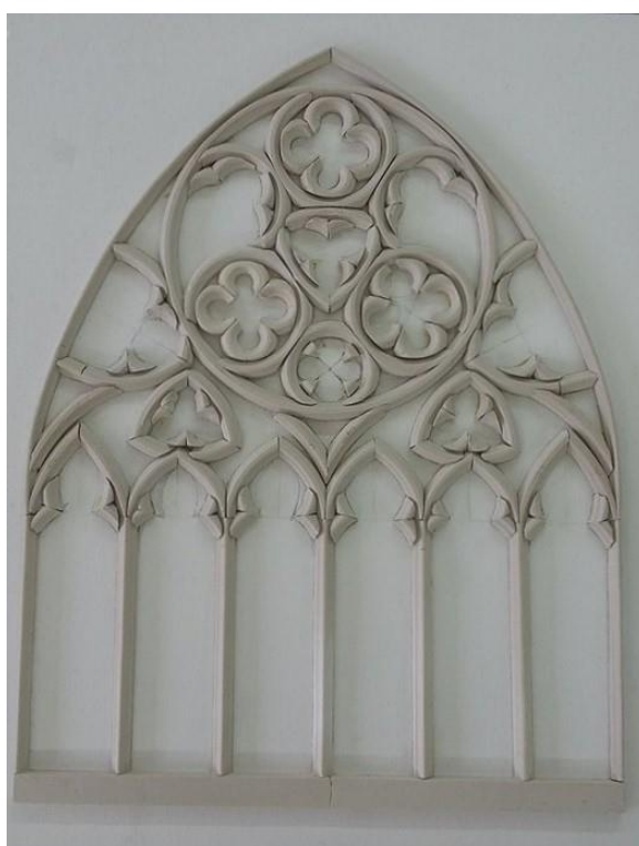
Obr. 164: Vytvořené jednotlivé segmenty a vložené do jednotlivých částí okna
