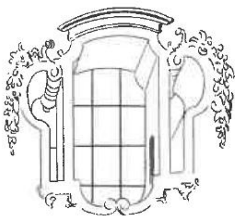
Obr. 42: Okno období rokoka – schované ve zdi
