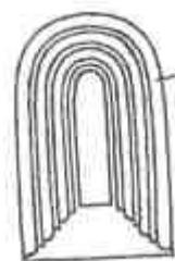
Obr. 2: Okenní otvor s pravoúhlým členěním špalety
