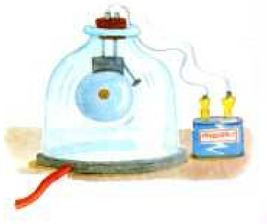
Obr. 5: Heuristický pokus – zvonek pod vývěvou [31]
