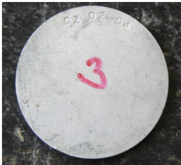
Obrázek 11 - Plošný zdroj CZ0203 ^{90}\text{Sr} + ^{90}\text{Y}
