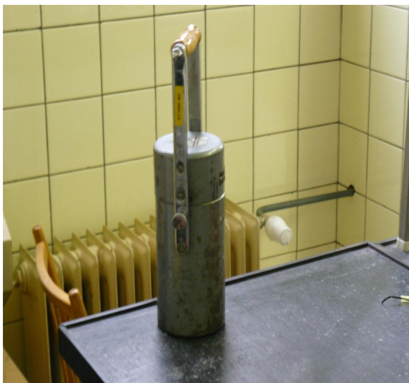
Obrázek 10 - Olověný přepravní kontejner na zářič ^{137}\text{Cs}
