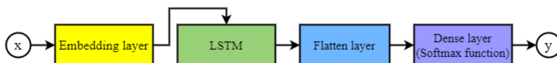
Obrázek 6.2 – Struktura modelu s rekurentní neuronovou sítí LSTM
