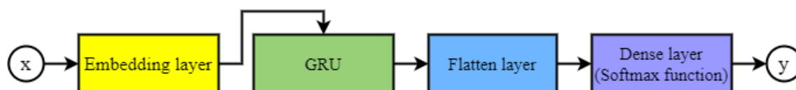
Obrázek 6.3 – Struktura modelu s rekurentní neuronovou sítí GRU
