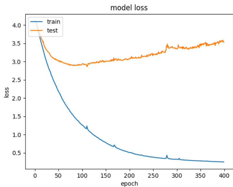
Příloha 7 - Ztrátová funkce modelu s dvouvrstvou strukturou modelu LSTM a regularizátorem L1
