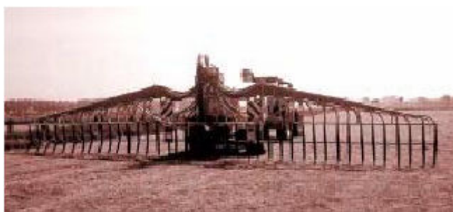
Příklad pásového rozmetadla vybaveného rotačním rozvaděčem ke zlepšení rozvádění kejdy
